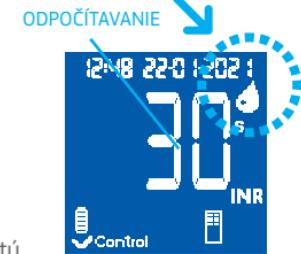
Ak použijete vzorku a neozve sa žiadny zvuk, znamená to, že vzorka nemá dostatočný objem. Vytiahnite použitý Chip a opakujte test s novým Chip. Uistite sa, že veľkosť kvapky je dostatočná a vstupný kanál nie je zablokovaný pri umiestňovaní.
